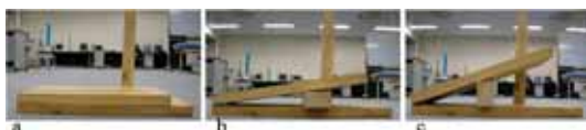
図 2. 背屈制限を模擬するための傾斜板 (a : 0度 b : 10度 c : 20度)
